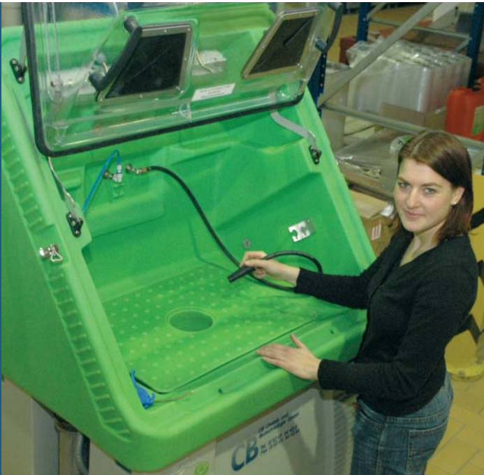
Diplom-Biotechnologin Nadine Kersting demonstriert die Funktionsweise der neuen Anlage zur biologischen Teilereinigung
