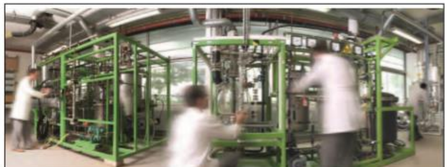
PPM betreibt eine in Deutschland einzigartige Versuchsanlage zur Gewinnung und Verarbeitung von Ölen und Proteinen aus nachwachsenden Rohstoffen im kleintechnischen Pilotmaßstab. Foto: PPM
